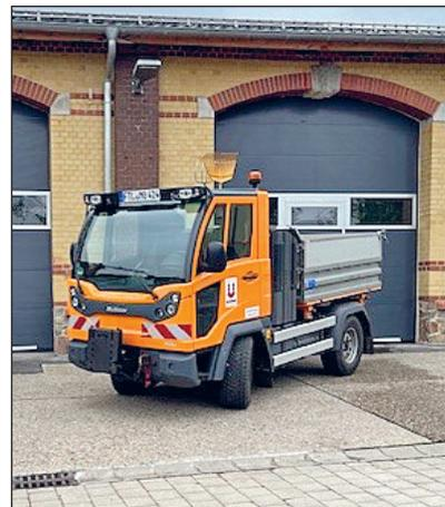
Firma Dietmar Franke Multicar aus Köttewitz. Es wurde ein Hako/Multicar M31C mit einem Turbodieselmotor F1C Euro 6D mit SRCT System zur Abgasnachbehandlung, Elektronisches Motormanagement mit elektronischer Arbeitsdrehzahlregelung und Tempomat und Common Rail-Einspritzsystem angeboten. Mit diesem Fahrzeug ist jetzt auch ein Einsatz im Winterdienst grundsätzlich möglich. Bei dem Fahrzeug handelt
