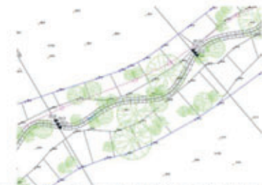
Abbildung 5: Planung der Bachprofilierung (Auszug); © TG Blankenstein / ÖkoProjekt ElbeRaum GmbH
