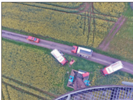
Blick von oben: Einsatzfahrzeuge als Anschlagmittel.
