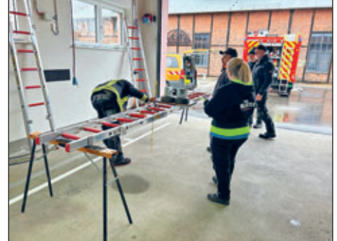
Prüfung der Steckleiterteile mit Prüfgewichten
