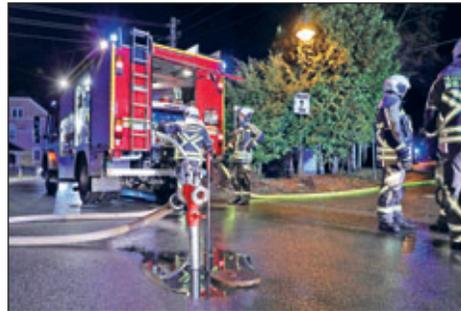
Löschwasserentnahme über einen Hydranten in die schmale Seitenstraße des Landbergwegs.
