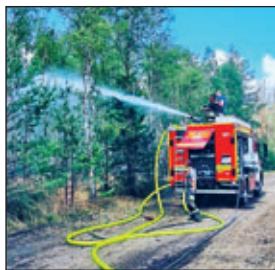
Mit dem Wasserwerfer vom Dach des Tanklöschfahrzeugs wird das Feuer bekämpft.
