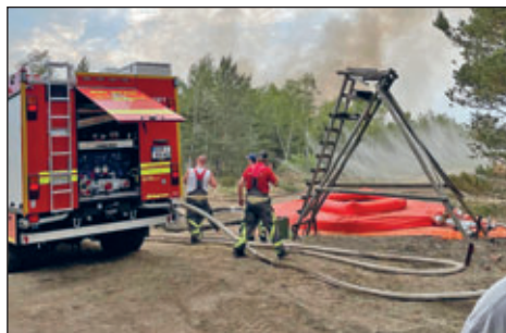
Mit dem Wasservorrat von 4.000 L wird eine Wasserblase gefüllt.
