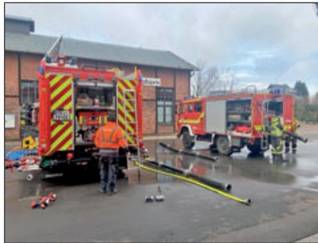
Prüfung der wasserführenden Armaturen
