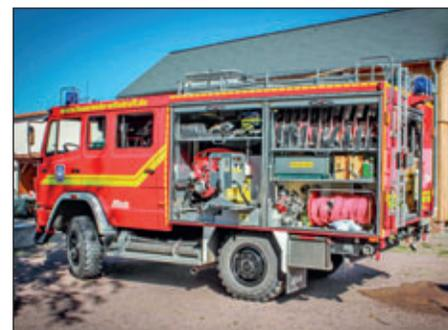
Linke Seite: Schlauchmaterial und Tragkraftspritze
